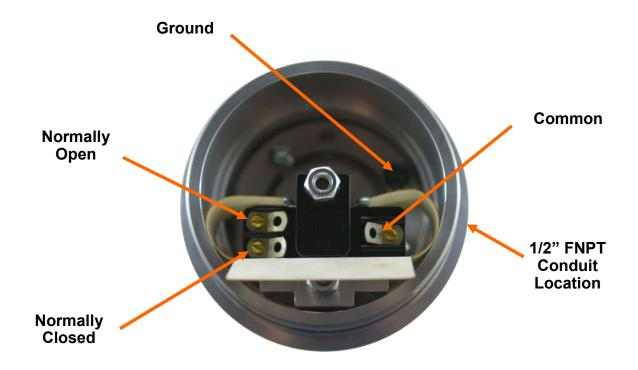
Single Pole Double Throw 15A—125, 250 or 480 VAC 1/4 HP—125 VAC, 1/2 HP– 250 VAC 1/2A—125 VDC, 1/4A—250 VDC
