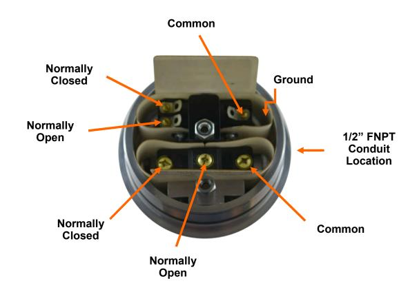
Manual Reset Microswitch Single Pole Double Throw 15A—125, 250 or 480 VAC 1/4 HP—125 VAC, 1/2 HP– 250 VAC 1/2A—125 VDC, 1/4A—250 VDC Auto Reset Microswitch Single Pole Double Throw 15A—125, 250 or 480 VAC, 2A—600 VAC 1/8 HP—125 VAC, 1/4 HP—250 VAC 1/2A—125VDC, 1/4A—250 VDC
